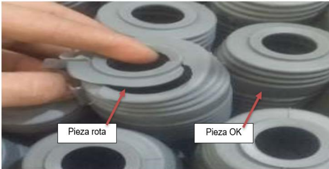
Figura 11: Piezas rota contaminada en las piezas OK Fuente: Propia.
