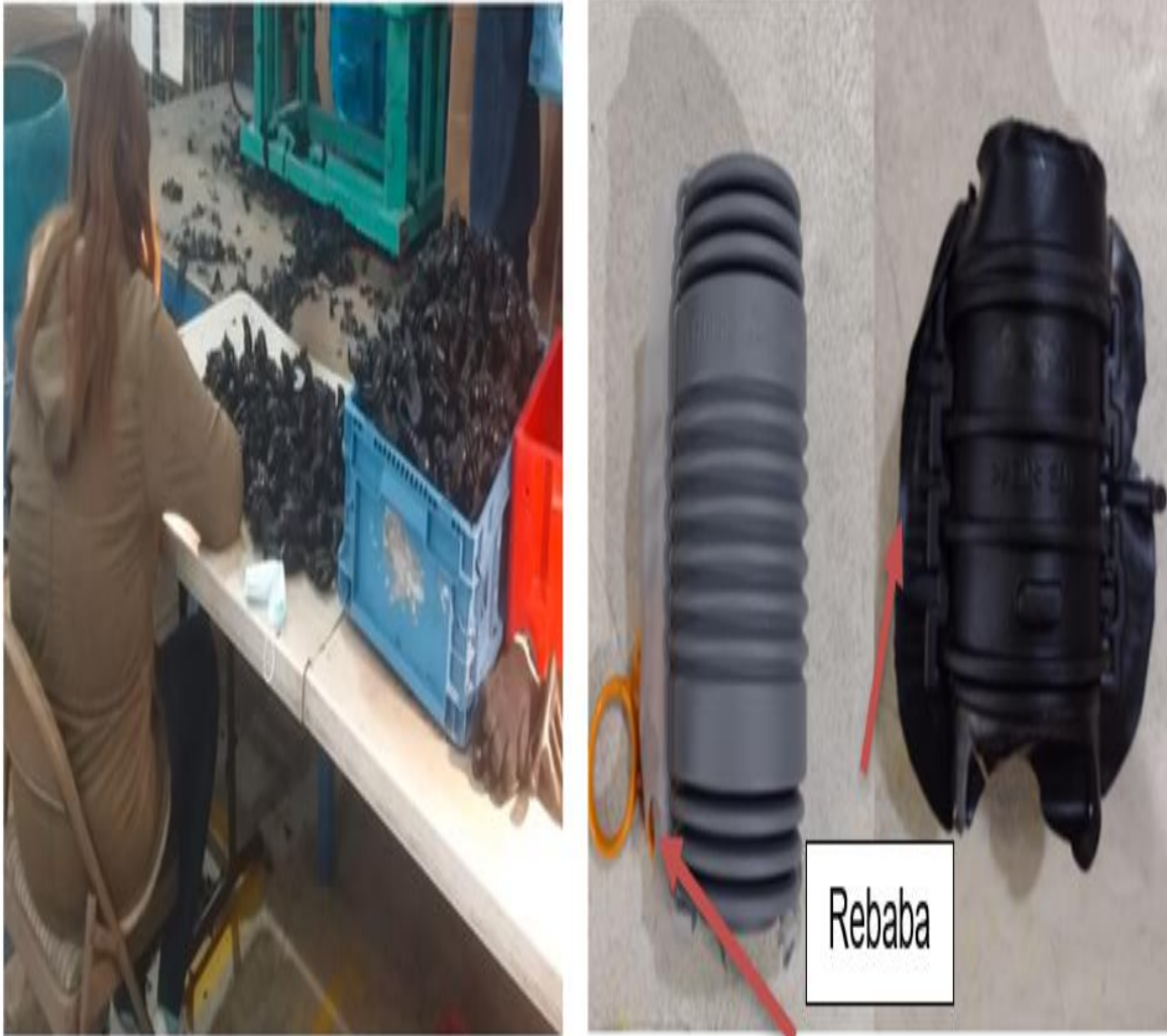
Figura 14: Acumulación de material por falta de rebabeo Fuente: Propia.
