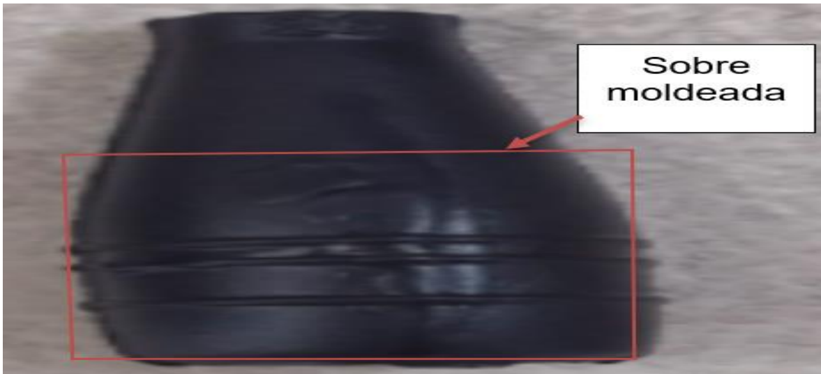
Figura 12: Pieza sobre moldeada (mala) Fuente: Propia.
