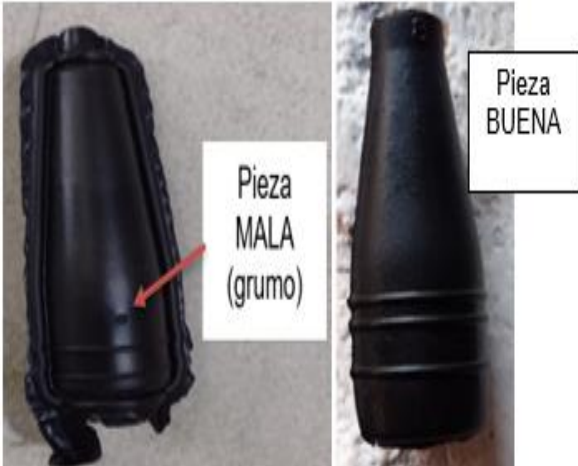
Figura 23: Pieza mala/ pieza buena Fuente: Propia.
